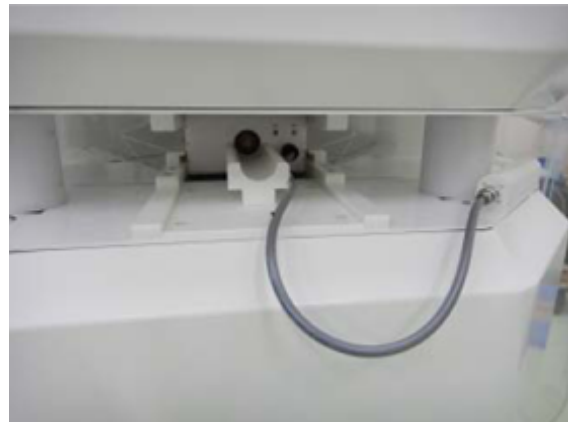
RF コイルの磁気回路部への接続例
